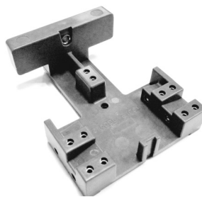
Шаблон для засверловки отверстий при монтаже скрытых направляющих
