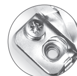
Эксцентрик для вертикальной регулировки в диапазоне ± 2 мм в лапке петли Soft Close 155°
